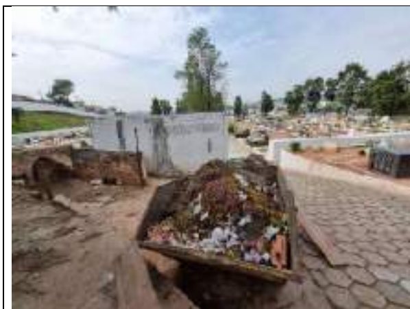
Foto 41 – Caçamba para acondicionamento dos resíduos cemiteriais (RDO, varrição, poda, capina e RCC)
